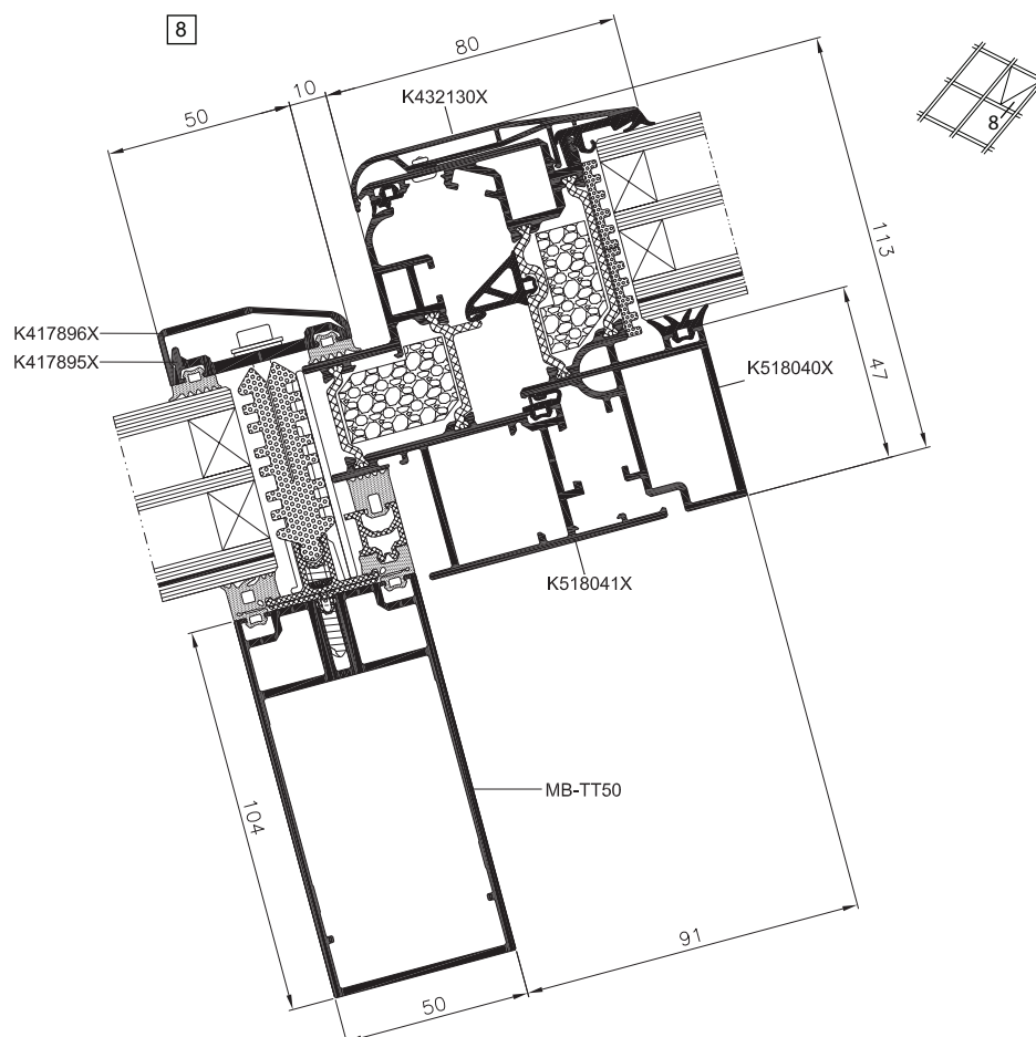
Řez příčnicí a střešním oknem MB-RW
